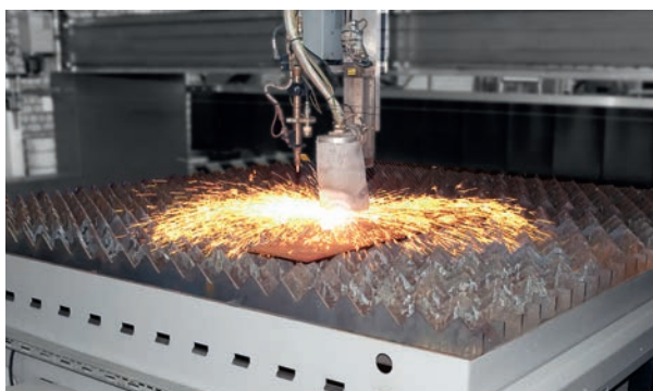
Svařovací stoly s odsáváním a stoly pro ruční řezání plazmou
